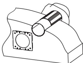
Установите секцию с вентилятором на монтажную пластину. Секция крепится к пластине за счёт магнитов
