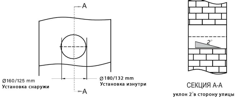
Соедините внутренний и наружный воздуховоды вместе, чтобы они соответствовали толщине стенки. Обрежьте трубу для установки в тонкую стену. Нанесите водостойкий уплотнительный клей на внутреннюю сторону резинового кольца, как показано на рисунке ниже.
