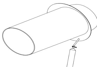
Просуньте воздуховоды через отверстия и потяните их назад, чтобы резиновое кольцо с внутренней стороны раскрылось и прилегло к наружной стене. Заполните зазор между стеной и воздуховодом монтажной пеной (используйте водостойкую герметизирующую пену для герметизации зазора внутри помещения для защиты от дождевой воды). Внутренний воздуховод должен быть параллелен внутренней поверхности стены.
